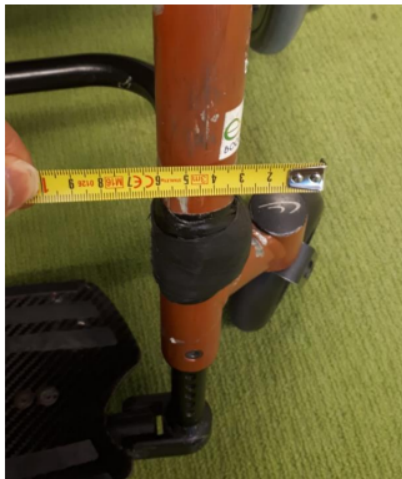
Figuur 2 diameter framebuis
